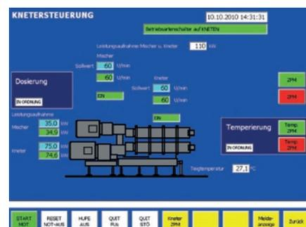
Zur übergeordneten Bedienung für den gesamten Teigerstellungsprozess kann das von **Werner & Pfleiderer als Option lieferbare Anlagenleitsystem** eingesetzt werden.
