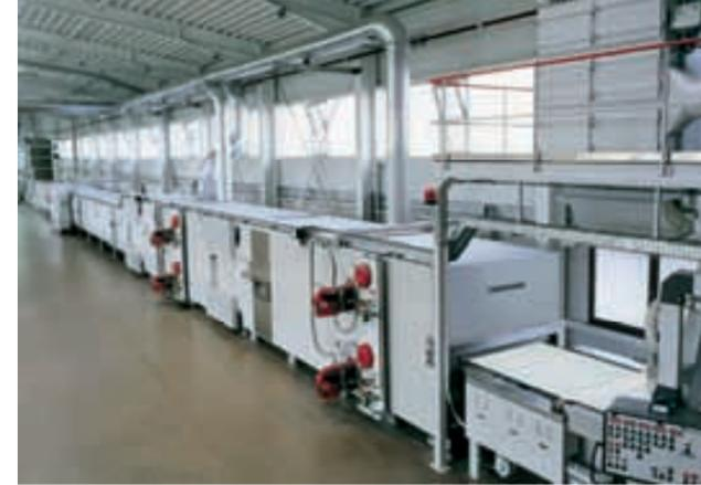
Qualitäts-Knäckebröt erfordert eine hohe Backraumtemperatur. Deshalb ist der WP-Knäckebrötöfen mit einem speziellen Heizsystem aus hochhitzebeständigem Material ausgestattet. Ein Blick durch eine Beobachtungstüre öffnet den Blick auf vollkommen plan-liegende Knäckebrötplatten während des Backprozesses.
