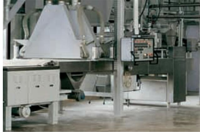
Knäckebrötanlagen werden in der Standardarbeitsbreite von 1550 mm gebaut.
