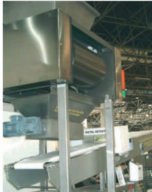
3 Emmouleuse avec tension et réglage de bande automatique. La plage de réglage étendue permet une adaptation optimale de la pâte et un moulage parfait des pâtons.
