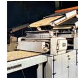
6 Une dresseuse automatique à haute performance produit des biscuits dressés de formes les plus diverses. Un distributeur de confiture permet la fabrication d'autres variantes de biscuit.
