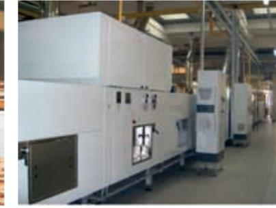
8 Le four à convection VARIOBAKE à haute performance atteint des courtes durées de cuisson tout en garantissant une qualité optimale des produits grâce à son système de circulation d'air.
